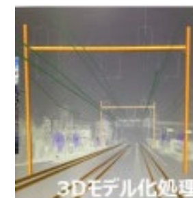
システム上で測量を実施
