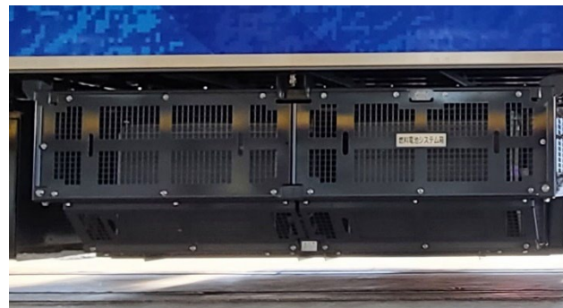
燃料電池装置
